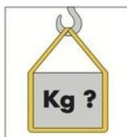
Controllare il peso del carico
