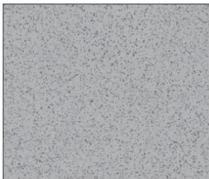
Uddeholm Vanax SuperClean – contenuto approssimativo di particelle di fasi dure 13%, 60HRC.
