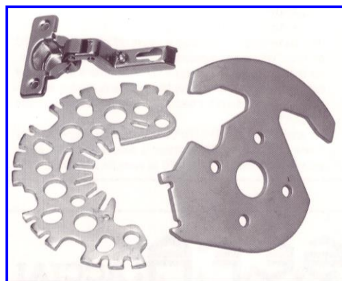
Particolari ottenuti con parti matrici in acciaio SA 2379
